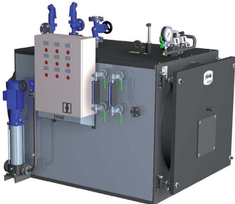
Генератор насыщенного пара среднего давления с инверсией пламени в топке, моноблочная конструкция из стали для сжигания топлива под наддувом с высокой энергоэффективностью. Предназначен для работы в сочетании с наддувной горелкой, работающей на газе или жидком топливе. Размеры топки с разворотом пламени и омываемым дном обеспечивают низкие тепловые нагрузки.
